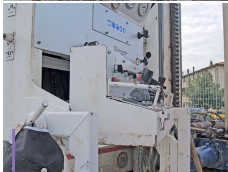
La console di comando è stata strutturata secondo le abitudini dell'operatore, inoltre è estraibile e, grazie a un cavo di prolunga di 5 m, è possibile seguire il lavoro a distanza, utilizzando un apposito piedistallo mobile.
