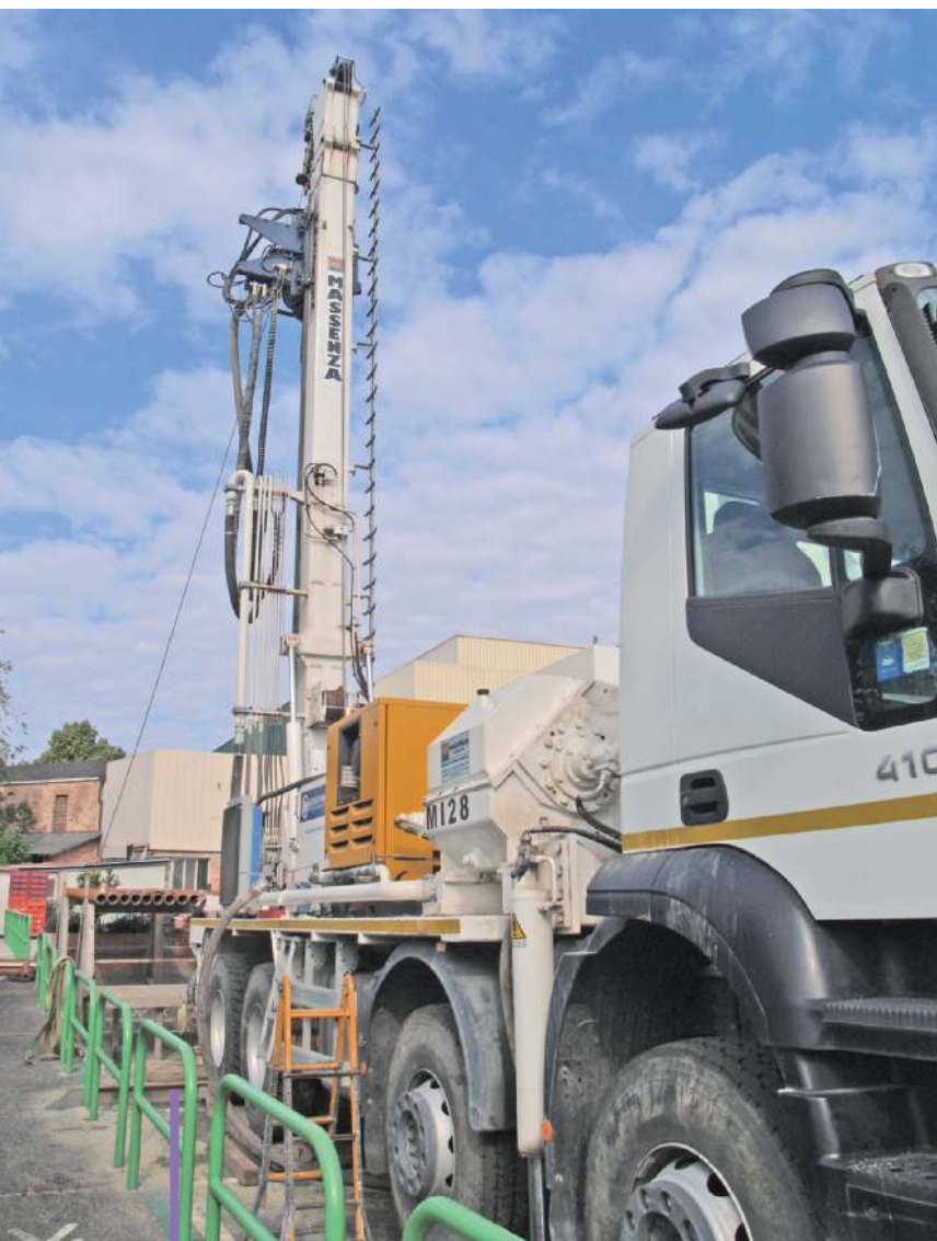
L'unità di perforazione in questo caso è allestita su un autocarro, ma può essere dotata di carro cingolato che ne permette la movimentazione autonoma.
