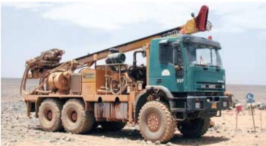
La perforatrice M.I.9 montata su un camion appositamente realizzato per operazioni in zone desertiche.
