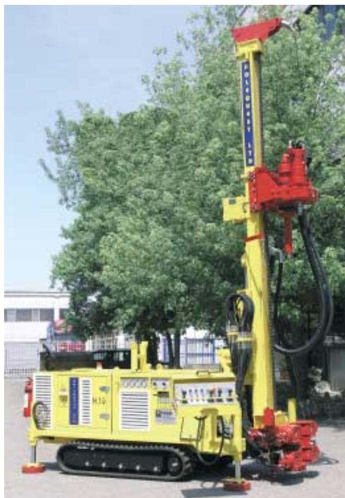
La M.I.4: tiro e spinta max 36/40 kN, corsa max 2/3,5. Testa di rotazione: coppia max 6.880 Nm, velocità max 650 rpm
