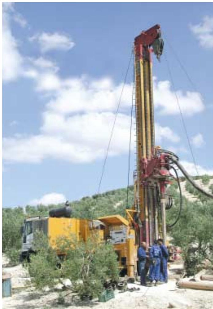
La M.I.45: testa di rotazione: coppia max 23.500 Nm, velocità max 170 rpm, passaggio (diretta) 76 mm, passaggio (inversa) 150 mm
