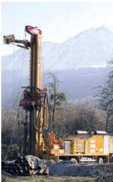
La M.I.60 è specializzata per pozzi d'acqua profondi, carotaggio e esplorazione mineraria con tutti i sistemi di perforazione
