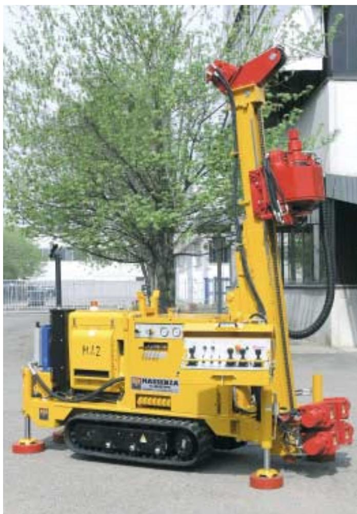
La M.I.2: una perforatrice versatile studiata per essere utilizzata nel settore geotecnico, geognostico, ingegneria civile, ricerche idriche, geotermia, ancoraggi, micropali e indagini ambientali. Tiro e spinta max 19 kN, corsa max 1,2 / 1,7 m
