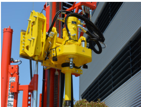
Testa di rotazione con martello a percussione Rotary head with hydraulic hammer Tête de rotation avec marteaux hydraulique Drehkopf bei hydraulii hämmer Cabeza de rotación con Martillo Hidráulico Головка вращения с ударным молотом
