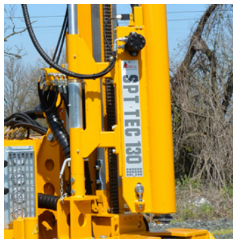
Penetrometro SPT SPT penetrometer Pénétrömètre SPT SPT penetrationsmesser Penetrómetro SPT Пенетрометр SPT
